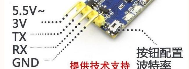
2.4G zigbee 无线串口透传模块
